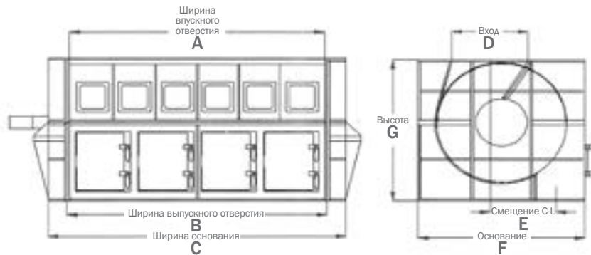
ПИТАТЕЛИ POSIFLOW ПРИБЛИЗИТЕЛЬНЫЕ РАЗМЕРЫ И ТРАНСПОРТИРОВОЧНАЯ МАССА
